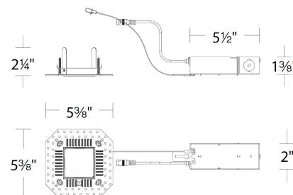
**R2FSRL** **1** **15W IC****R2FS-**\_\_\_\_\_Example: **R2FSN1L-1**
